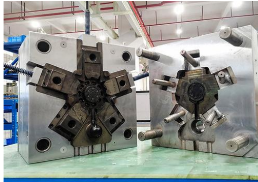
Gambar 12. Dies(cetakan) untuk pengecoran logam Aluminium dengan cavity (lubang) dan pinn insert yang bergesekan dengan logam cair. [12]
